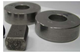
Рис. 1. Образцы для измерения износостойкости
