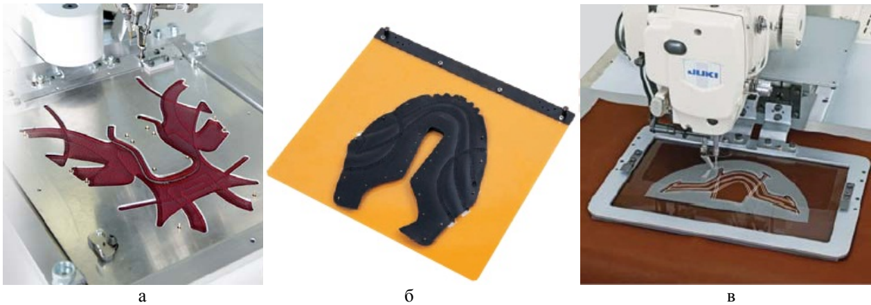
Рис.2. Пристосування для силової фіксації деталей заготовки взуття: а – палета металева; б – палета з пластику; в – п'яльця
