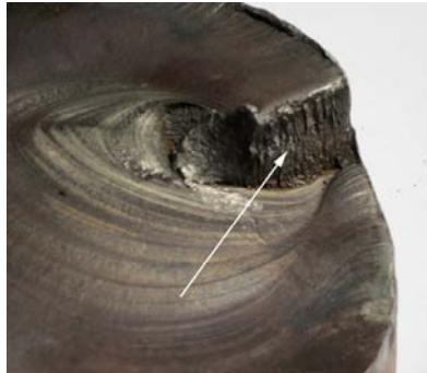
Рис. 2. Вид участка разрушения вала ТЭД от крутящего момента
