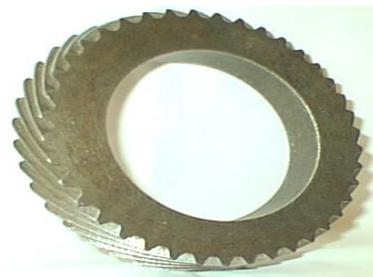
Рис. 4. Квазигиперболическое колесо с  $z_2 = 40$ ;  $m = 1,5$  мм;  $\beta = 60^\circ$
