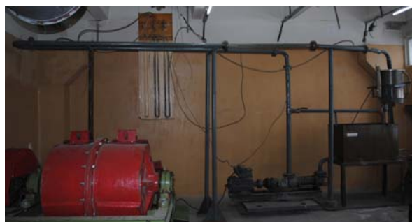
Рис. Экспериментальная установка для исследования реологических и гидродинамических характеристик ВУТ
