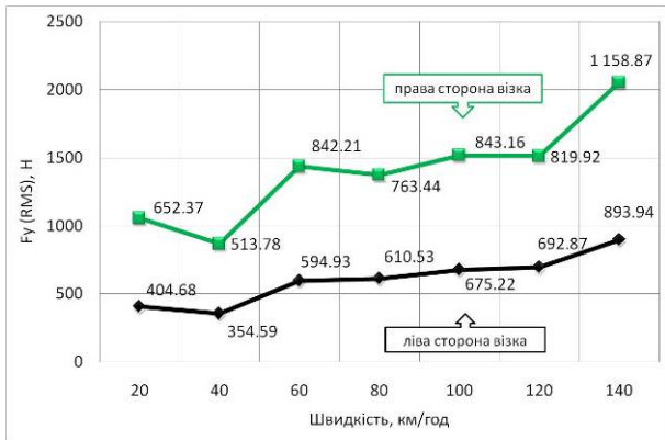
Рис. 4. Залежність СКВ (RMS) бічних зусиль F_y , які передаються на вузли кріплення гідравлічного амортизатора при жорсткості повідка Спов. = 4700 кГ/см в маршрутному діапазоні швидкостей до 140 км/год на прямолінійній ділянці колії з нерівностями
