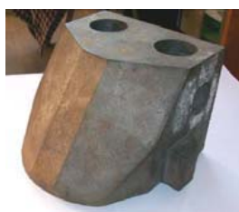
Рис. 7. Клин просторової конфігурації візка 18-1711
