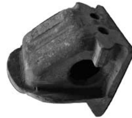
Рис. 3. Фрикційний клин плоскої дії зі збільшеною висотою вертикальної поверхні країн СНД
