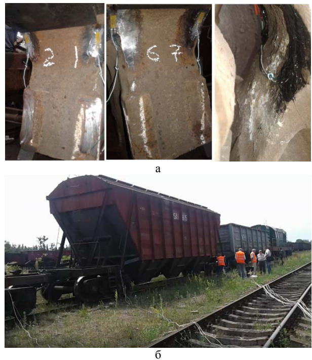
Рис. 5. Ударні випробування: місця наклейки тензорезисторів (а); загальний вигляд дослідного вагону (б)
