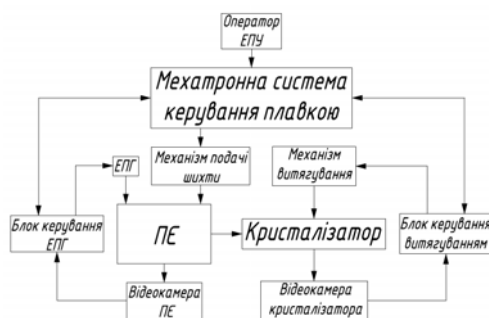
Рис. 8. Схема мехатронної системи керування ЕПП
