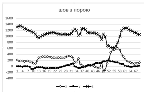
Рис. 7. Магнітне поле для зразків із зварним швом та поодинокую порою
