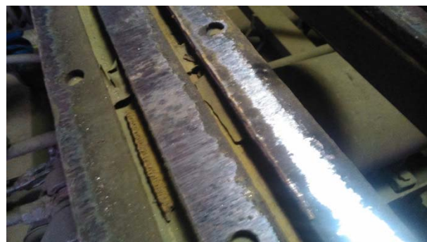
Рис. 7. Нагортання міді з контактного дроту на полоз струмоприймача і псування шунтуючих пластин
