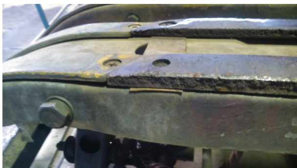
Рис. 8. Перекриття шунтуючими пластинами технологічних отворів на полозі
