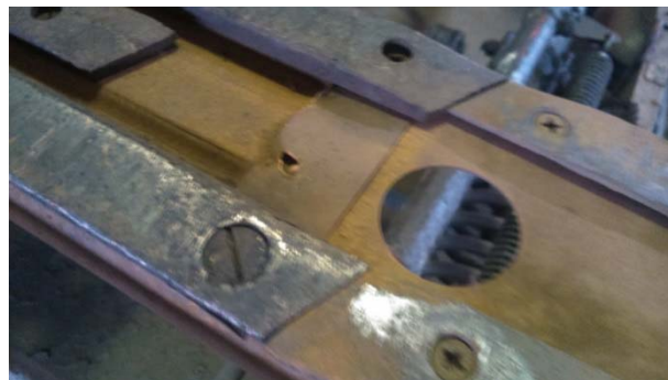
Рис. 6. Псування шунтуючих пластин на полозі
