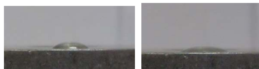
Рис. 5. Крапля розчину на зразку з алюмінію після вібраційного шліфування 1 і 5 секунд
