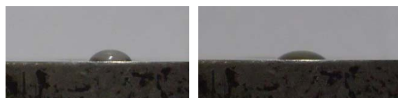
Рис. 8. Крапля розчину на зразку зі сталі після традиційного шліфування 1 і 5 секунд
