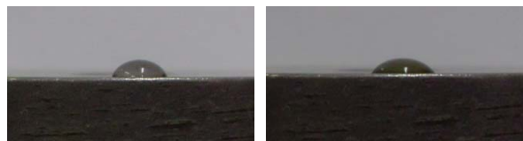
Рис. 9. Крапля розчину на зразку зі сталі після вібраційного шліфування 1 і 5 секунд
