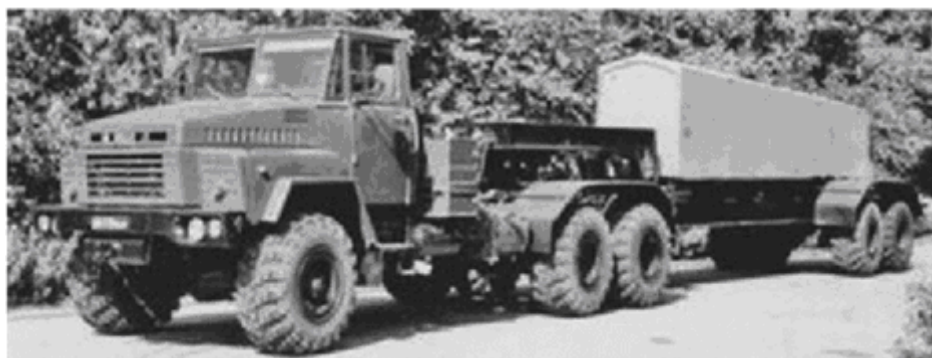
Рис.1. Активный автопоезд с механическим приводом [3]
