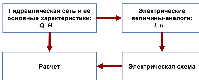
Рисунок 3 - Принцип электрогидравлического моделирования
