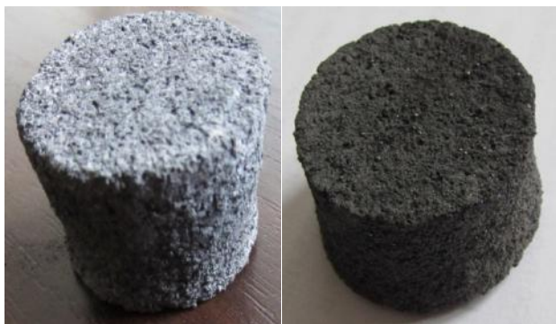
Рисунок 4 – Дослідні зразки, спечені в режимі СВС
