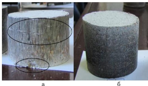
Рисунок 3 – Сформовані зразки без додавання (а) та з додаванням клею (б)
