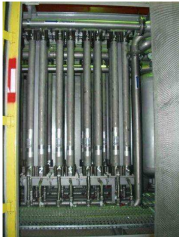
Рисунок 22 – Мембранний модуль станції АМГП-15/0,7 С У1
