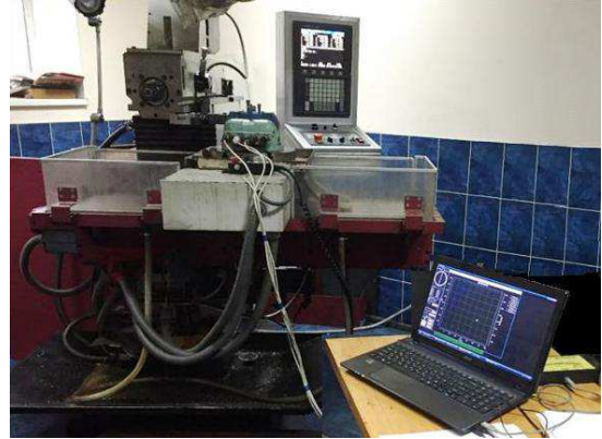
Рисунок 7 – Загальний вигляд вимірювального станда на базі верстата з ЧПК мод. OMM64SCE02 й динамометра УДМ-600
