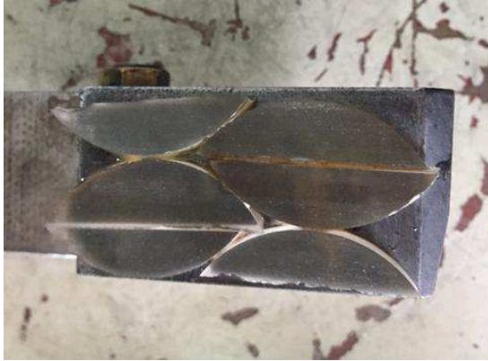
Рисунок 6 – Загальний вигляд досліджуваних зразків сафіру, наклеєних на державку, після попереднього плоского шліфування
