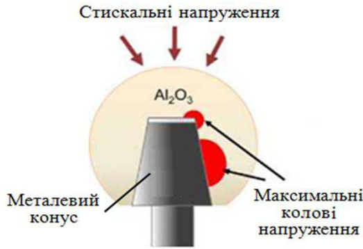
Рисунок 1 – Схематичне зображення протезу стегнової головки з кераміки Al_2O_3 на металевій шийці нижки штучного суглоба [6]
