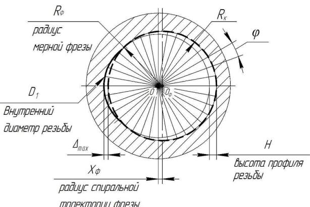
**Рисунок 1 – Схематический профиль резьбы в поперечном сечении детали**
