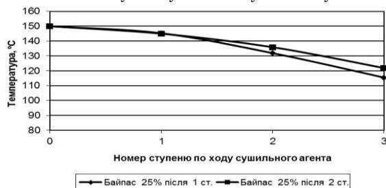
Рисунок 11 – Вплив способу байпасування сушильного агента на зміну температури сушильного агента
