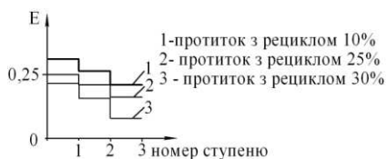
Рисунок 7 – Вплив способу рециркуляції сушильного агента на ефективність процесу сушіння
