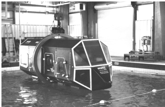
Рисунок 2 – Модульный тренажёр для отработки эвакуации
