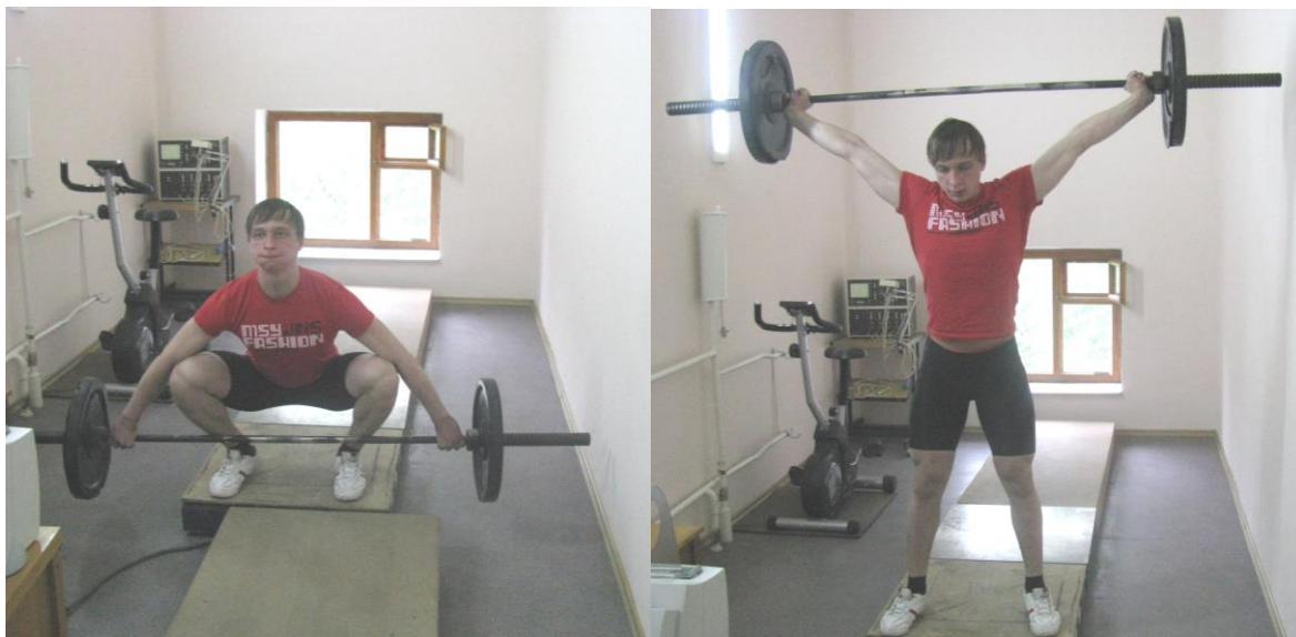
Рис. 1. Фрагмент проведення тензодинамометричних вимірювань опорних реакцій важкоатлетів при виконанні ривка
