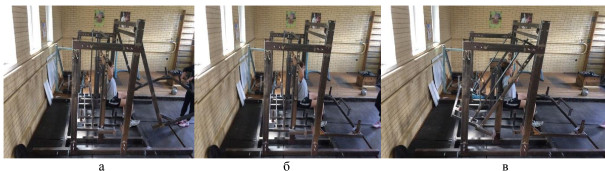
Рис. 1. Последовательность операций ударного воздействия на специфические мышечные группы метателей копья: а – отведение ударного механизма, б – ударный контакт, в – вызванное отклонение от вертикали передающего механизма
