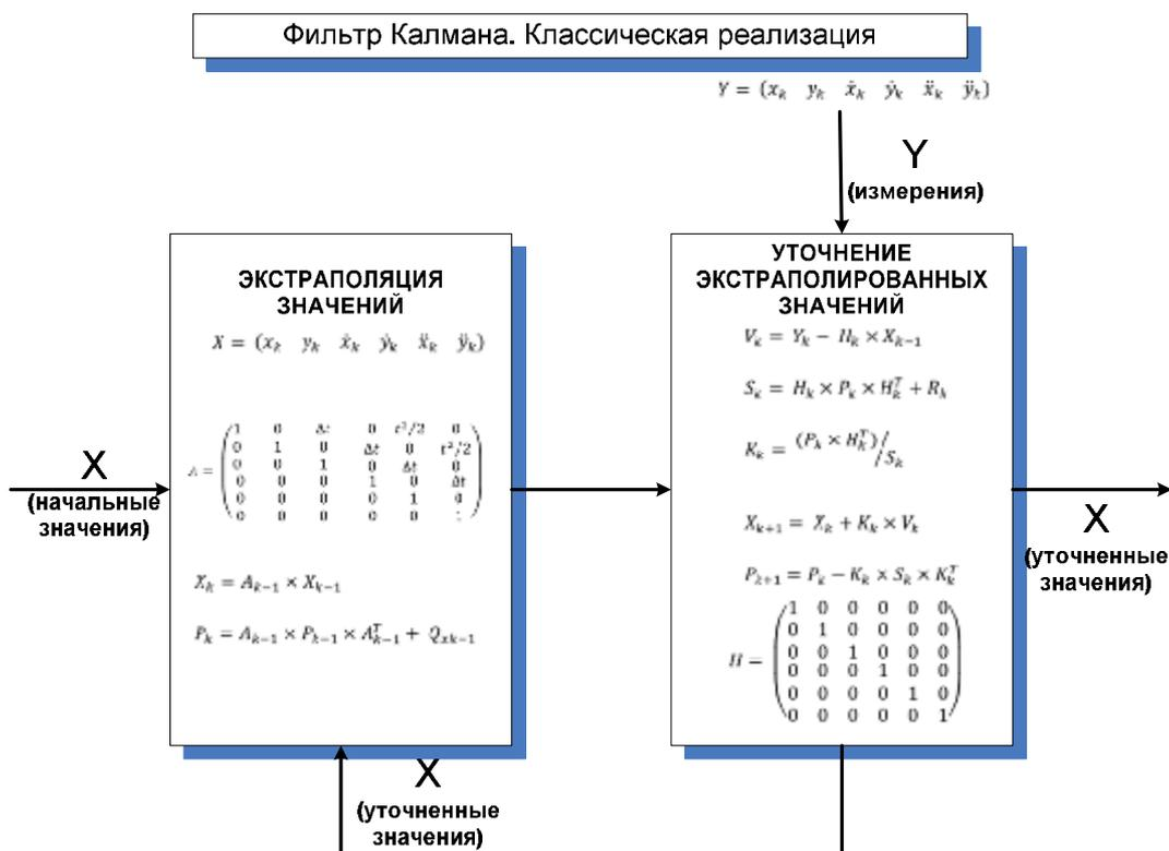
Рис. 1. Модель алгоритма классического фильтра Калмана
