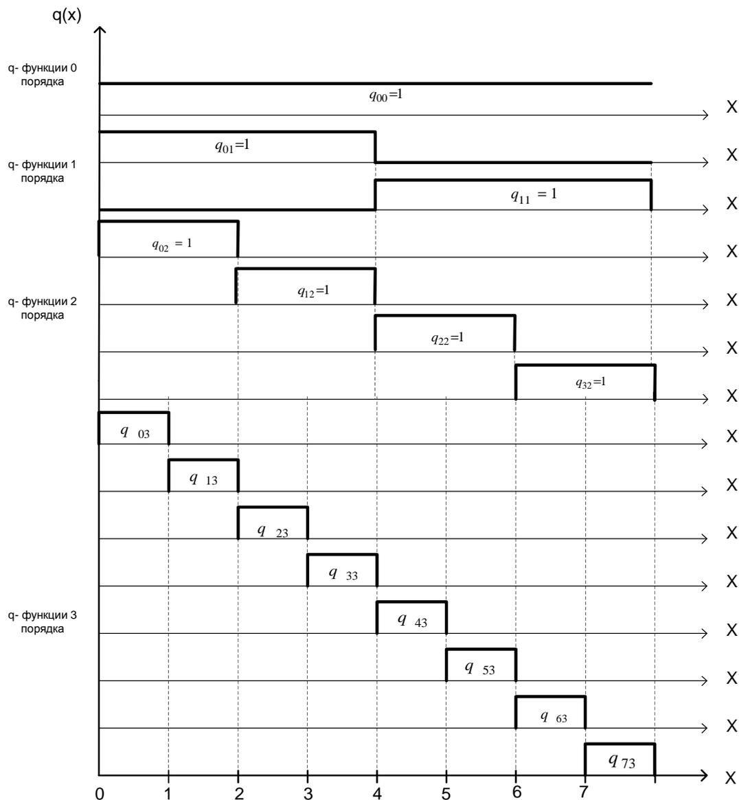
Рис. 3. Расширенная система q-функций n=3
