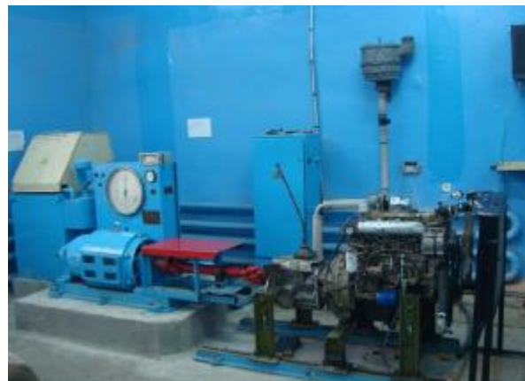
Рис. 1. Загальний вигляд гальмівного стенда з дизелем СУ4102ВZQ
