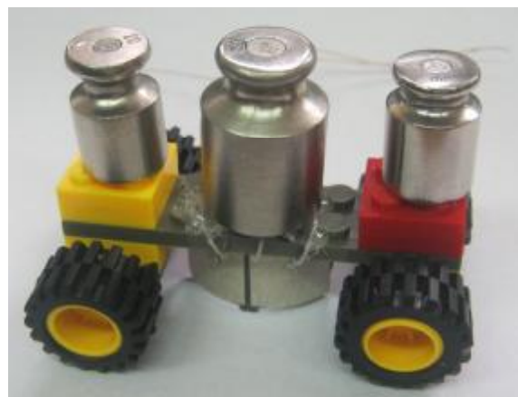
Рис. 5. Грузоподъемность разработанного пьезодвигателя
