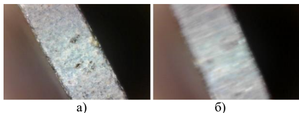
Рис. 10. Экспериментальные результаты свободной стороны пьезоактуатора под микроскопом, увеличение 250 крат: а) в состоянии покоя; б) при подаче напряжения 100 В с частотой 146 Гц
