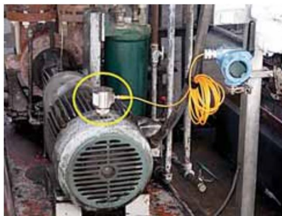
Рис. 1. Установка віброгенератора Vulture на промисловому двигуні [1]
