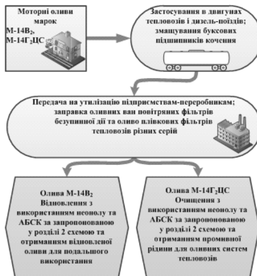
Рис. 4. Функціональна еколого-хіммотологічна модель поводження з моторними оливами на залізничному транспорті
