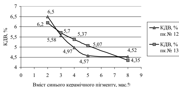
Рис. 3. Залежність КДВ (%) покриттів від вмісту в них синього пігменту № 210
