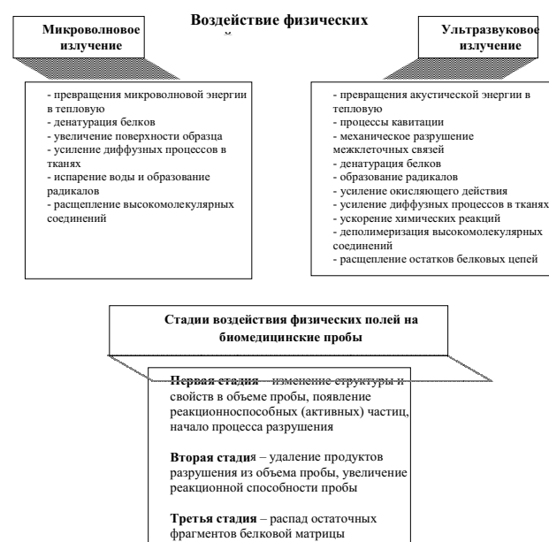
Рис. 1. Эффекты и стадии воздействия физических полей на биоматериалы с различной природой матрицы
