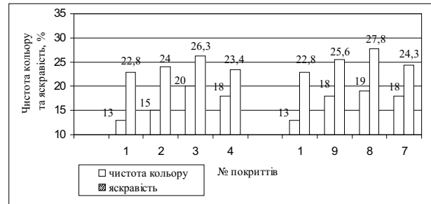
Рис. 4. Залежність чистоти кольору та яскравості дослідних покриттів від хімічного складу емалей
