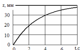
Рис. 3. График изменения высоты заполнения капилляра z от времени по оси капилляра при тех же параметрах, что и на рис. 2
