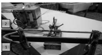
Рис. 1. Загальний вигляд експериментальної електродугової установки: 1 – пристосування для електродіскрового оброблення; 2 – трансформатор
