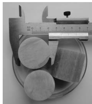
Рис. 1. Стеклокомпозитные цилиндрические образцы для исследования водопоглощения
