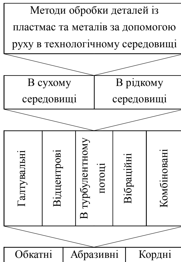
Рис. 2. Класифікація методів обробки виробів із пластмас і металів рухом виробів в середовищі
