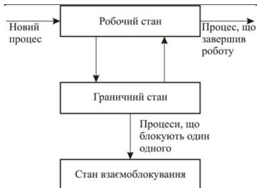
Рис. 2. Схема переходу процесів у стан взаємоблокування
