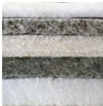
Рис. 2. Зразок нетканого матеріалу «Спрут»
