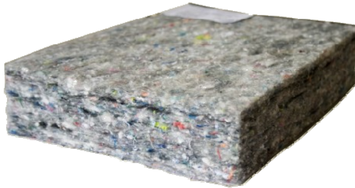
Рис. 3. Зразок нетканого матеріалу Термофлекса
