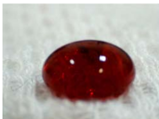
Рис. 2 Крапля рідини на гідрофобному трикотажному полотні
