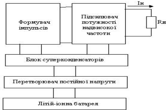
Рис. 2 Вдосконалена структурна схема генератора зонduючих імпульсів надширококумгуових мобільних радіолокаторів
