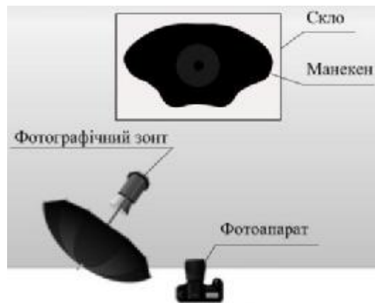
Рис. 4. Схема установки для фотографування
