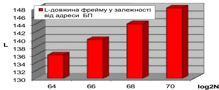
Рис. 6. Довжина фрейму у залежності від довжини адреси банків пам'яті
