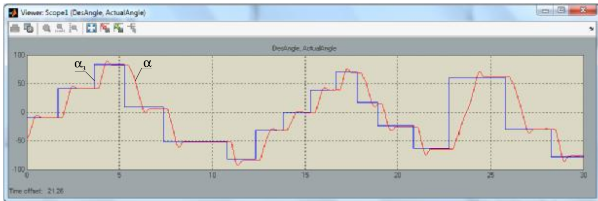
Рис. 14. Графіки сигналу задання та відпрацювання задачі системою
