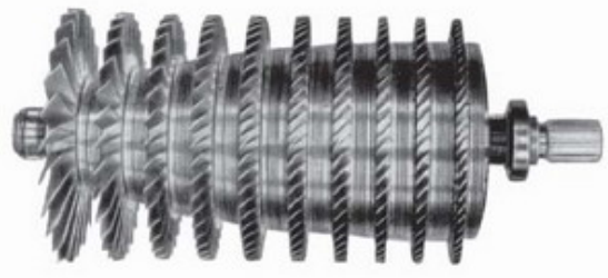
Рис. 2. Зовнішній вигляд ротора компресора газотурбінного двигуна АІ-20
