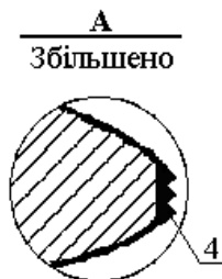
Рис. 4. Збільшена проекція конструктивного виконання вершин рифлів валка м'яльної машини
