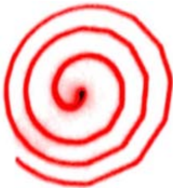
Рис. 19. Візуалізація руху дзеркального диску, запущеного “з ребра” шліфованою площиною стола (на завершальній стадії руху)
