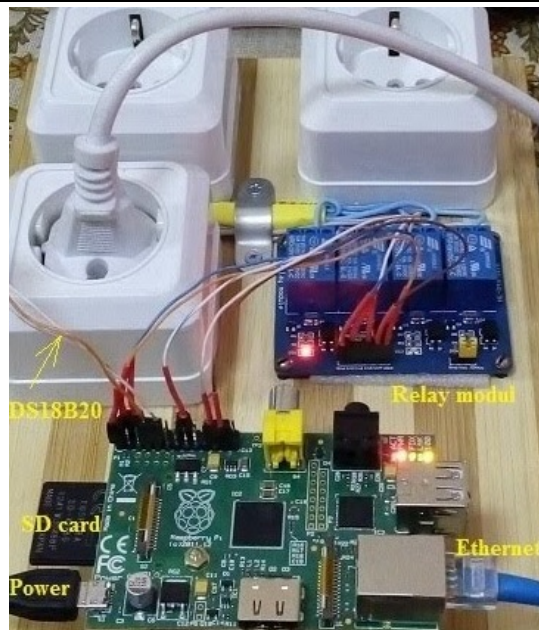
Рис. 2. Фото системы управления электропитанием
