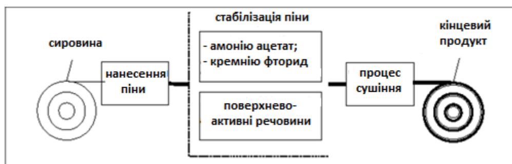
Рис. 3. Схема процесу опорядження за пінною технологією
