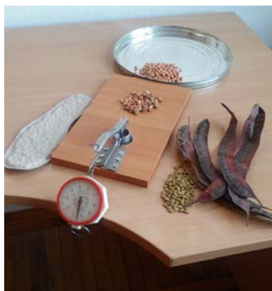
Рис. 5. Пристрій для визначення міцності кісточок плодових рослин, підготовлений до роботи
