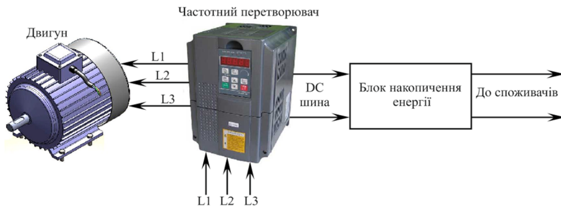
Рис. 5. Блок-схема запропонованого пристрою рекуперації енергії
